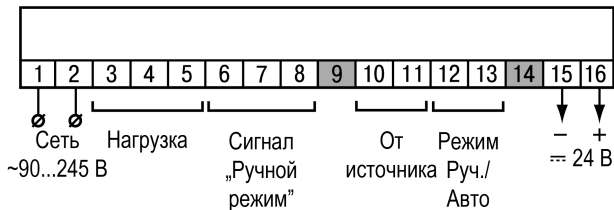
Рисунок 5.4 – Назначение контактов клеммника в приборах модификации УЗС1-Н.Х, УЗС1-Щ1.Х и УЗС1-Щ2.Х
